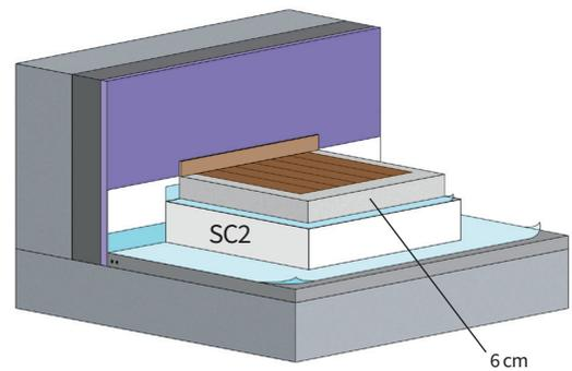
Isolation en pose scellée directe d'un carrelage sur forme
