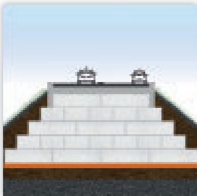
Allègement sur sols compressibles
