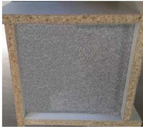
Photo 1 – coffrage d'éprouvette PSE pour coulage du béton
