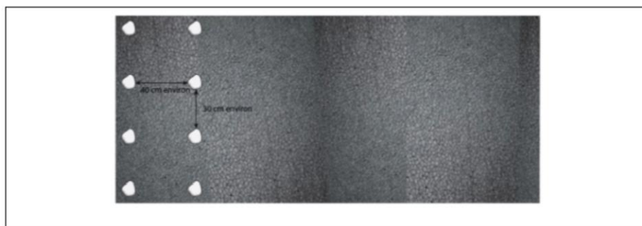
Figure 6 – Mode de collage : Collage en plots - répartition des plots de Map® Formule +
