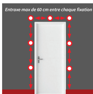
Cas particulier des portes de 2040 x 730 mm
