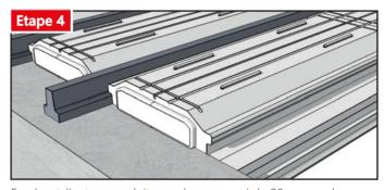
En about, l'entrevous doit prendre un appui de 20 mm sur le mur extérieur.
