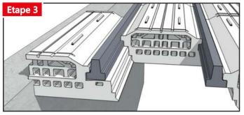
Découper l'entrevous de rive en s'assurant d'un appui minimum de 20 mm sur le mur extérieur.
