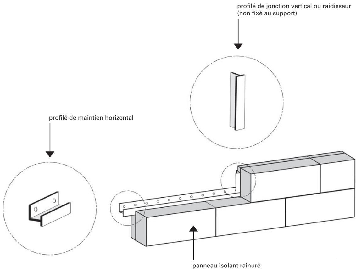
**Figure 5a – Fixation des panneaux isolants par profilés – Utilisation de raidisseurs**
