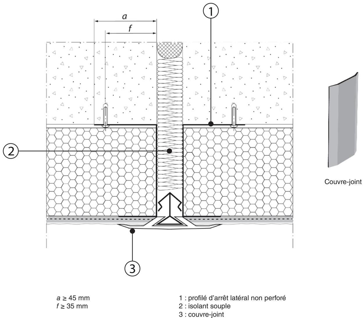
**Figure D2.1 – Joint de dilatation en partie courante
