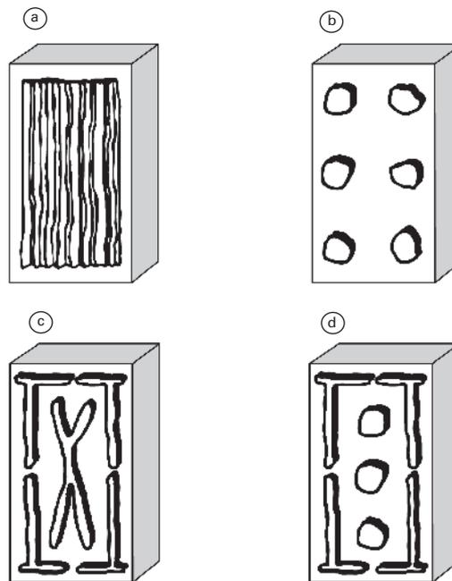
**Figure 4 – Modes de collage/calage des panneaux isolants (exemples).**
