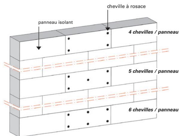
**Figure 6a – Fixation des panneaux isolants par chevilles – Disposition en plein (exemples)**
