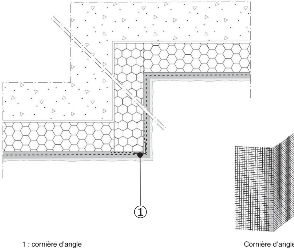
**Figure C1 – Angles verticaux sortants et rentrants
